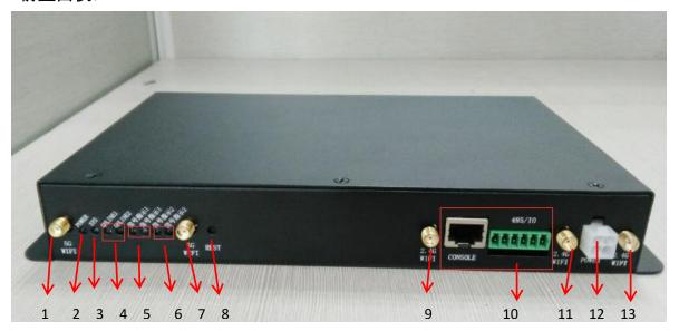
1: 5GWiFi 天线接口 2: 电源灯 3: 进程灯 4: sim 卡 1, sim 卡 2 上线灯 5: sim 卡 1 信号指示 灯 6: sim 卡 2 信号指示灯 7: 5GWiFi 天线接口 8: 复位键 9、11、13: 2.4GWiFi 天线接口 10: 串口 12: 电源插口
